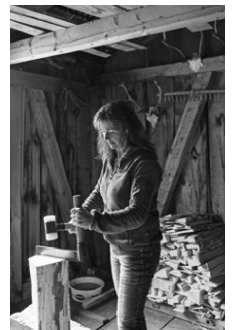
Traditionelles Handwerk: Eva Gredig spaltet Holzschindeln, mit denen verfallene Scheunen neu gedeckt werden
